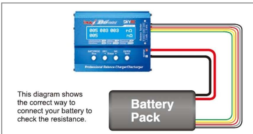
Данная схема показывает правильный способ подключения вашей батареи для проверки напряжения.
